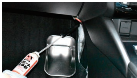
車内助手席側排水ドレンより注入
