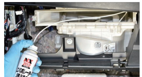
ブロアファンの間隙から注入
