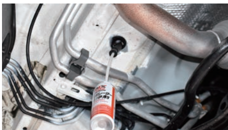
車体下部排水ドレンより注入
